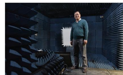
Pr Ke Wu dans une chambre anéchoïde permettant de mesurer les performances de différents prototypes d'antennes
