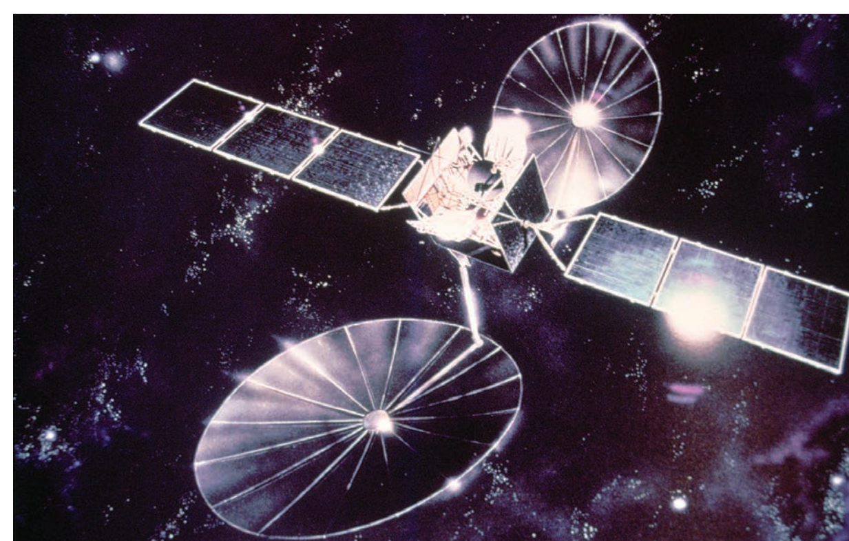
Satellite MSAT utilisé pour les communications cellulaires. Ses paraboles permettent de faire converger (focaliser) les signaux de cellulaires sur la zone de couverture choisie. Crédit : Centre de recherches sur les communications Canada
